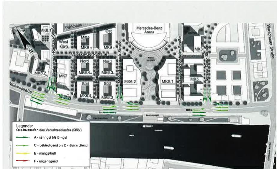
Bild 6: Beispiel für Ergebnisse einer Leistungsfähigkeitsprüfung mit den Qualitätsstufen des Verkehrsablaufes an Knotenpunkten. Quelle: Masterplan Anschutz-Areal in Berlin-Friedrichshagen, 2016
